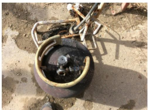
Incendie d'une bouteille de gaz dans une collectivité lors du désherbage des trottoirs avec un désherbeur raccordé à du butane. Suite à un défaut dans les dispositifs piezo et des anti retour, la flamme est remontée jusqu'à la bouteille, laquelle est partie en détresse, l'ouvrier communal n'a pas eu le temps de fermer la vanne car son pantalon a pris feu ; les pompiers ont dû intervenir en plein centre-ville pour éviter l'explosion de la bouteille.
